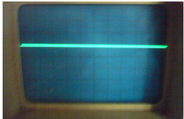
Fig. 5c. Rectifier output Voltage
